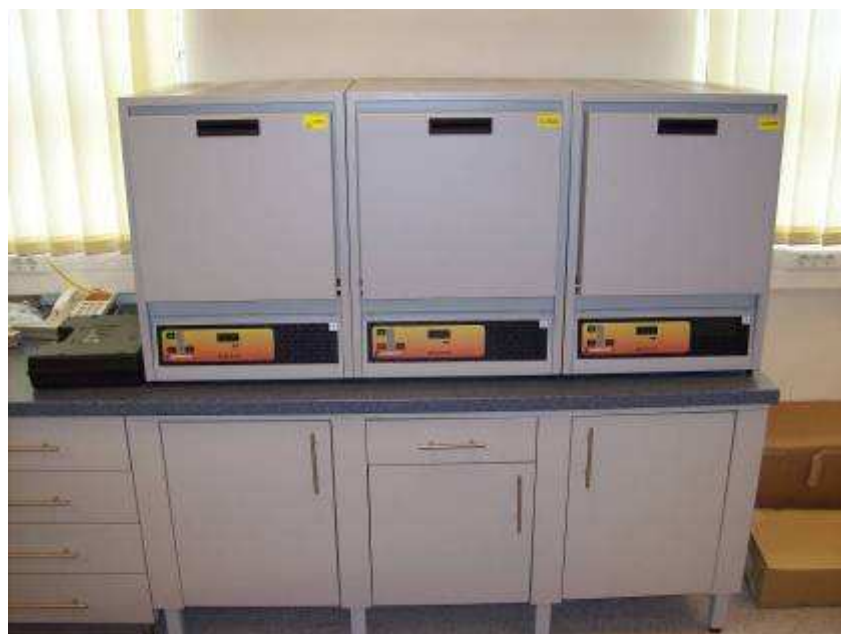
Carbolite type 301 izzító kemence (3 db)
