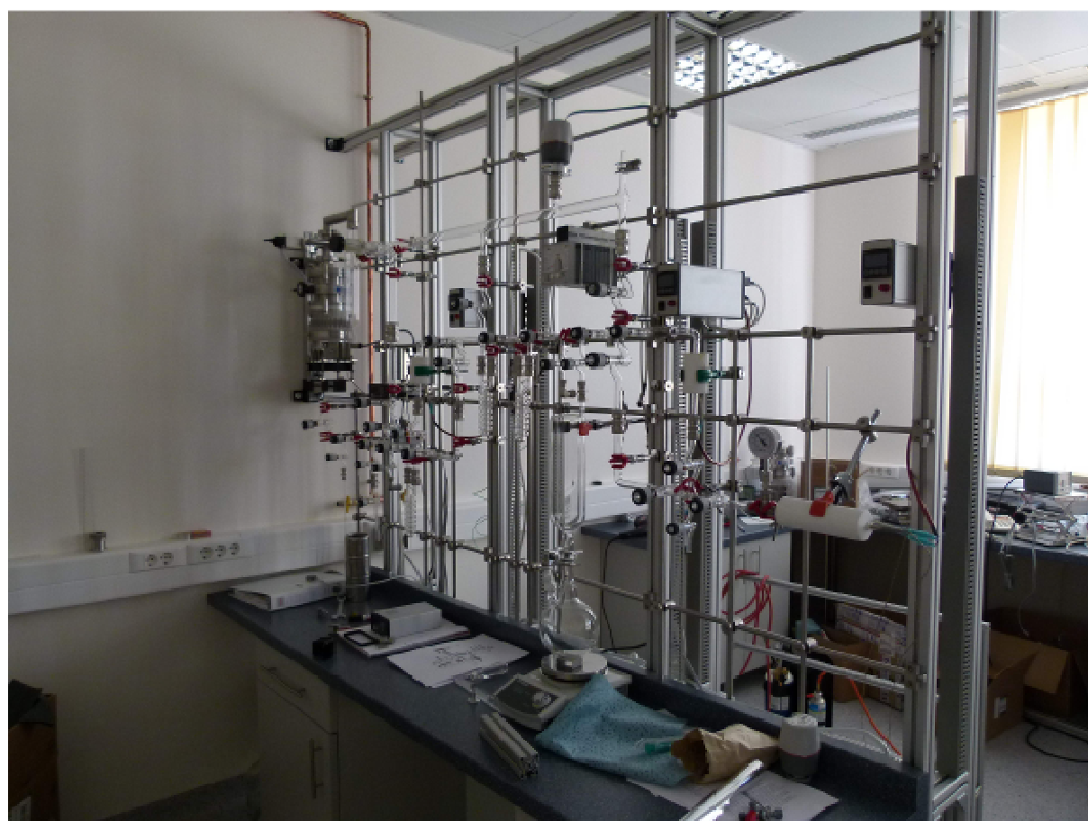
AMS égető-feltáró rendszer állványa (Isotoptech Zrt. - HEKAL fejlesztés)
