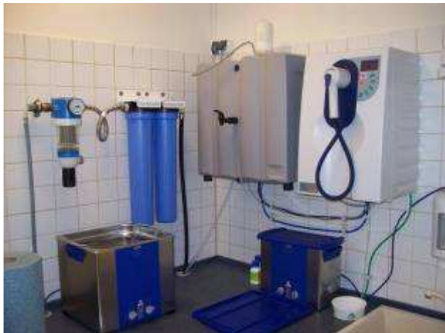
Ultra Clear TWF UV Plus víztisztító egység Alatta a két ultrahangos kád (18 és 6 liter)
