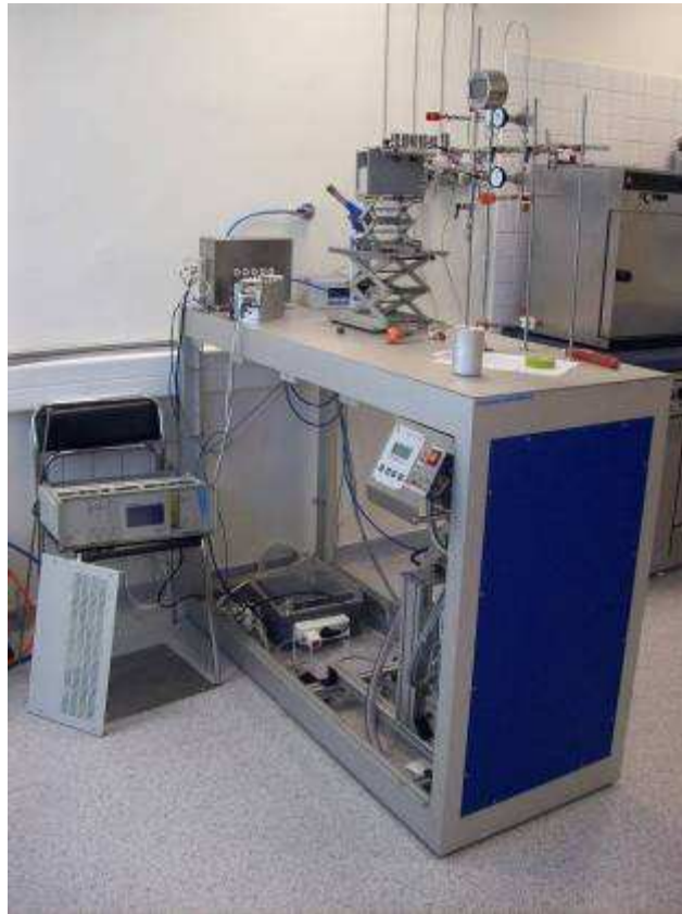
AMS grafit-preparáló gázkezelő berendezés (Isotoptech Zrt. - HEKAL fejlesztés, próba verzió)
